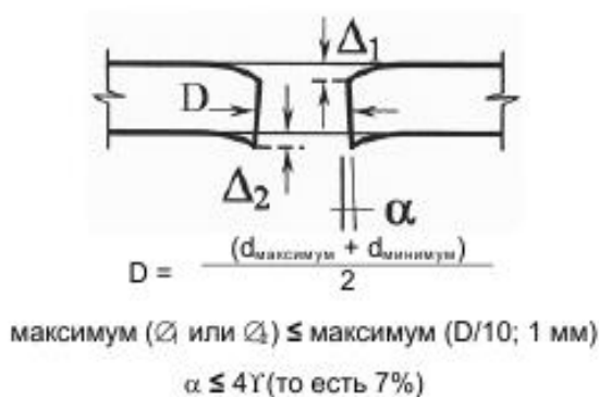
Рисунок 6.6 - Допустимые деформации перфорированных отверстий и плазменных резок
