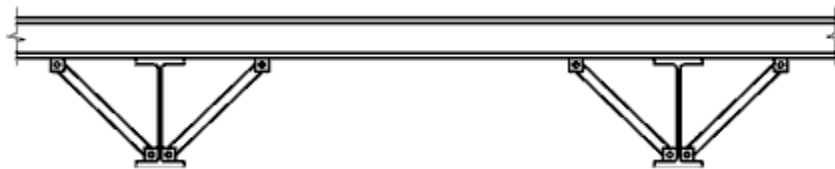
Рисунок 7.2 - Типовое жесткое закрепление от кручения
